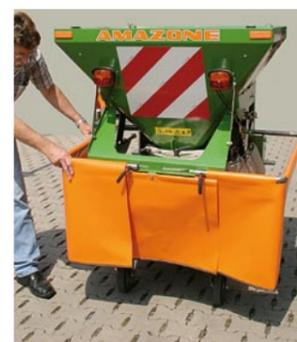
С помощью просто устанавливаемого устройства для точного распределения E + S переоборудуется в зимний коммунальный распределитель с точной регулировкой ширины распределения от 80 до 120 см. Таким образом, например, можно точно посыпать велосипедные дорожки.
