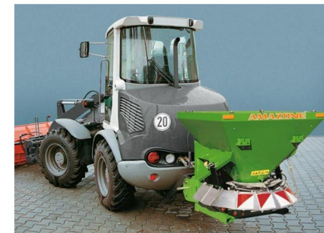
Привод с гидравлическим мотором позволяет, например, выполнять работу с одним колесным погрузчиком.
