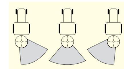
Важно: Простое одностороннее распределение справа или слева путем отклонения распределяемого потока.
