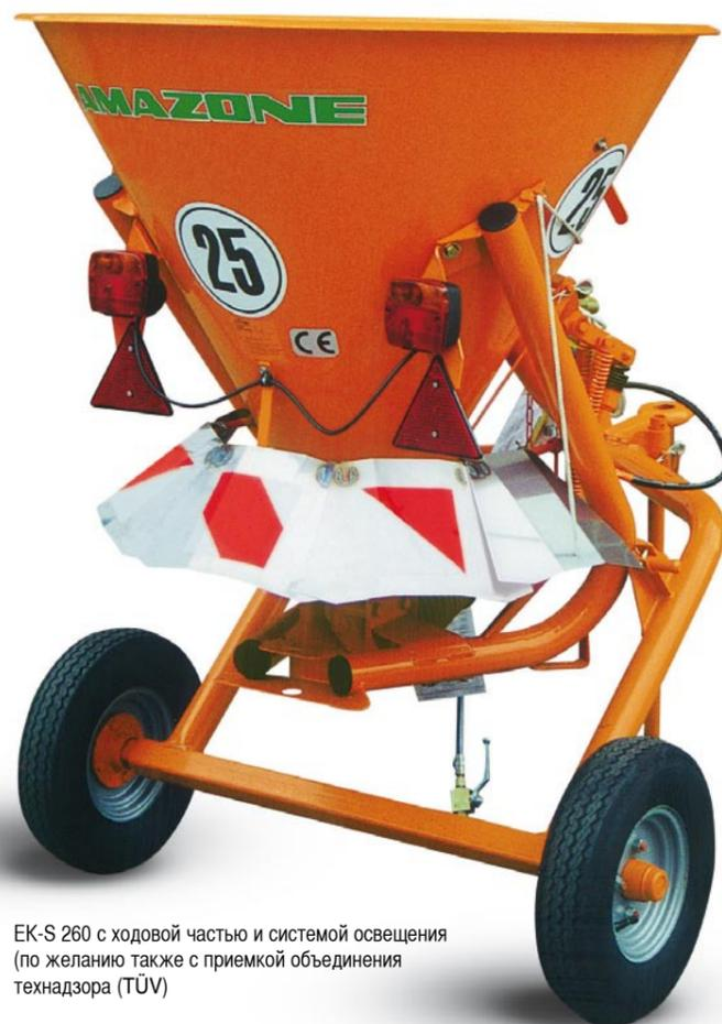
ЕК-S 260 с ходовой частью и системой освещения (по желанию также с приемкой объединения технадзора (TUV))
